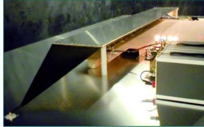
Prüfung einer Fahrzeugkomponente nach der Fahrzeugrichtlinie in der Streifenleitung. Foto: SLG
