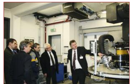
Zur modernen technischen Ausstattung des Instituts gehört ein Vakuum-Hochgeschwindigkeits-Rotorprüfstand für Zyklen- und Berstversuche.
