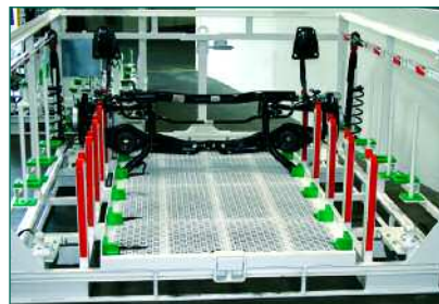
Die von CARTECH entwickelten und produzierten Behälter basieren auf Grundgestellen, die im Baukastensystem mit modularisierten Aufbauten bestückt werden. Weniger Materialeinsatz beim Behälterbau, optimaler, qualitätsgerechter Transport sowie ebensolches Teilehandling beim Einlegen und Entnehmen sind Effekte, die mit diesen Produkten erzielt werden. Foto: Reichel
