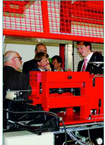
Auf solchen Hochgeschwindigkeits-Ziehschälanlagen von Kieselstein wird u. a. hochwertiger Federdraht für die Automobilindustrie hergestellt.
