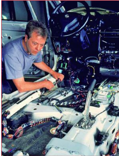
Kabelsatzeinbau bei Leoni. Der weltweit tätige Hersteller errichtet gegenwärtig eine Produktionsstätte in Bautzen. Foto: Leoni AG
