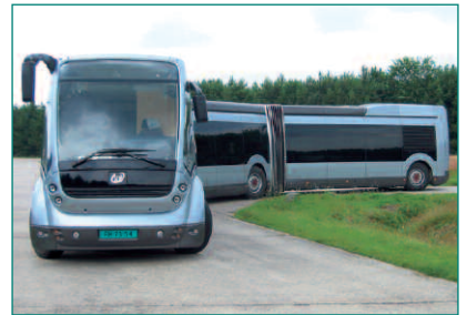
Ihre Entwicklungs- und Fertigungskompetenz für Speziallenkgetriebe haben die sächsischen Unternehmen FTL und RBL am Beispiel dieser Busse nachgewiesen. Sie fahren spurgeführt. Je nach Konfiguration sind sie bis zu 24 Meter lang und können bis zu 200 Personen fassen. Maximal vier einzeln gelenkte Achsen, zwei Gelenke und elektronisch angetriebene Räder machen sie enorm wendig. Foto: APTS
