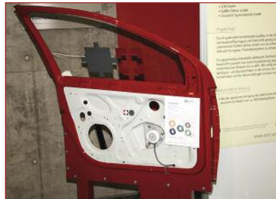
Tür mit neuem elektrischem Kunststoffmotor von der Steffen Söhner GmbH für den Fensterheber. AMZ unterstützt bei der Entwicklungsplanung und Kontaktabstimmung zu potenziellen Kunden. Fotos: RKW Sachsen GmbH
