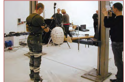
In verschiedenen Abschnitten eines Probekörpers führt der Werker Einschraubbewegungen durch. Die Abläufe werden genau erfasst und ausgewertet. Sie dienen als Grundlage für die Erstellung einer Typenbewegungsdatenbank.
