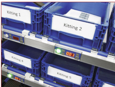
Das neue Kommissioniersystem KIT TO LIGHT ist in diesen Wagen integriert. Foto: LOGSOL
