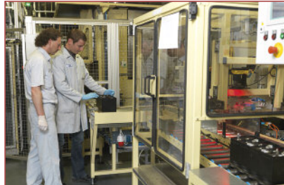
AGM-Batteriefertigung bei Johnson Controls Zwickau: Kontrolle der korrekten Widerstandsschweißung und der Polausrichtung. Foto: Johnson Controls
